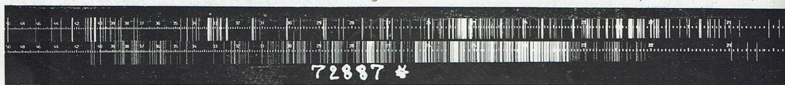
Fig. 3. — Espectrograma del Cobre y del Hierro
