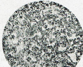
Micro de un acero al 0,5% de C
