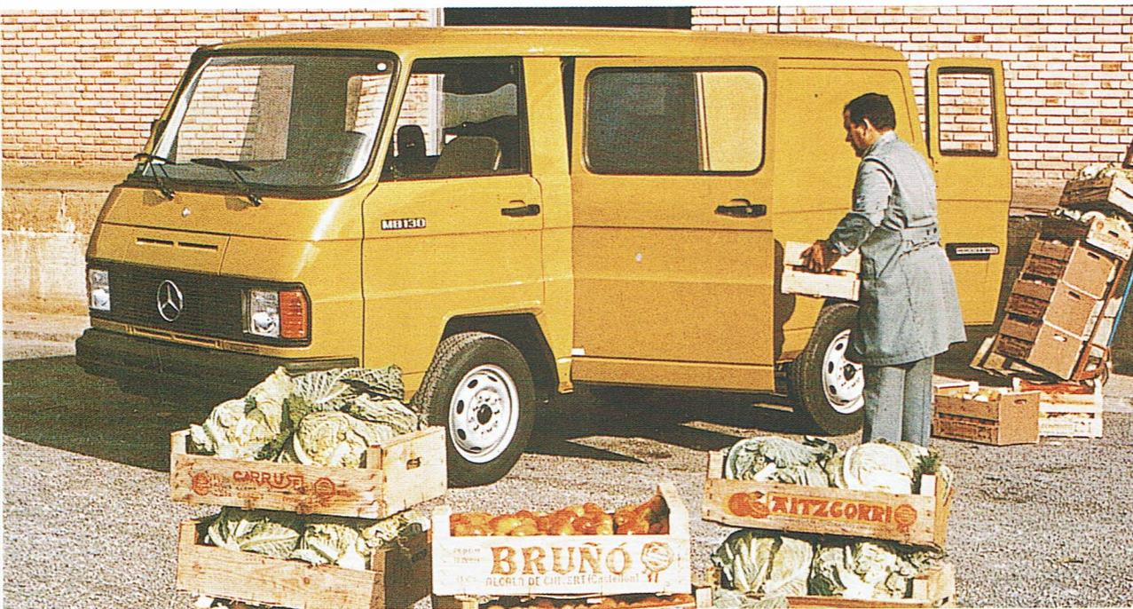
En la producción de estos polivalentes vehículos, la planta de Vitoria hacía las estampaciones de chapa, ensamblaje, montaje y acabado de carrocerías y la de Barcelona, los motores, cajas de cambio y mecanización general.
