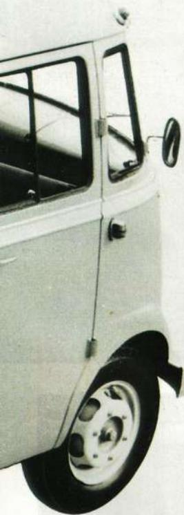
*La Telefónica tuvo una extensa flota de vehículos Mercedes-Benz L-319 D. El de la imagen es un chasis con cabina carrozado como furgón taller para reparar averías en la línea telefónica.*
