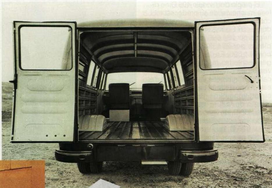
*La Mercedes-Benz 405 D era idéntica a la L-319 D salvo en el motor. Sus 55 CV le permitían llegar a los 100 km/h. Obsérvese su gran volumen de carga aun en la versión Combi.*
